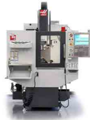
Haas Mini Mill 16 x 12 x 10" 406 x 305 x 254 mm 7.5 hp 5.6 kw 6000 rpm
