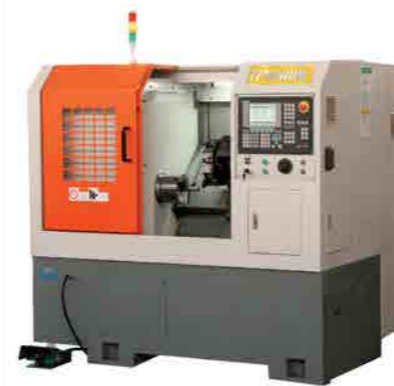
Titanium CK7130BP Máx. turning diameter(mm): 350 Slide stroke X-axis (mm): 350 Paso de barra (mm): 36
